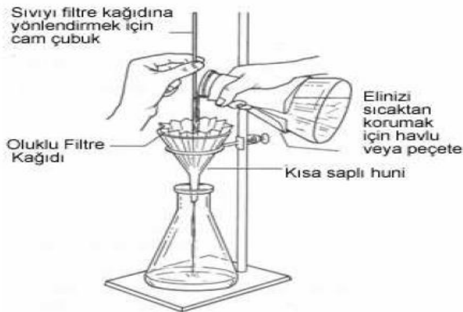
Şekil 1. Sıcak Çözeltinin Süzgeç Kağıdı Kullanılarak Süzülmesi
