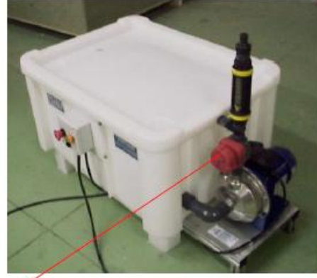
Şekil3:Hidrolik tezgah ve hidrolik grup akış kontrol vanaları
