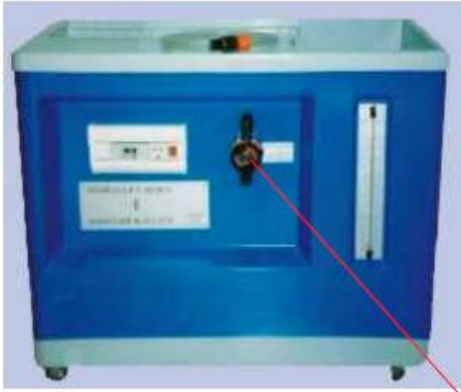
Şekil3:Hidrolik tezgah ve hidrolik grup akış kontrol vanaları
