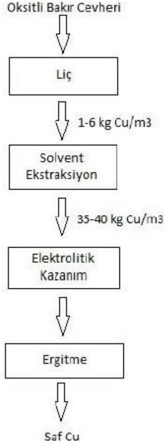
Şekil 1. Hidrometalurjik bakır (Cu) üretim diyagramı
