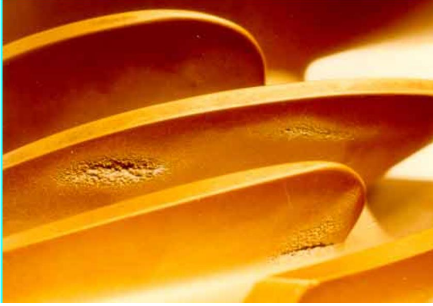
Şekil 5. Karışık akışlı bir pompada oluşan tipik kaviteasyon hasarı (Blake, 1996).
